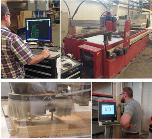
그림 5. 워터젯(Water jet) 기기 제어 및 디자인 모델 최종 점검 작업(위) CNC 기기 제어 및 실시간 모니터링(아래)
