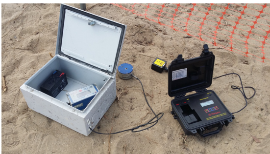
Fig. 3. Minimete 장비와 HLS-01 비교 측정.
