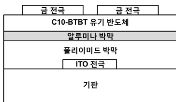
그림 5. 알루미늄/폴리이미드 이중층 게이트 절연체를 도입한 유기 박막 트랜지스터의 단면 모식도. 25
