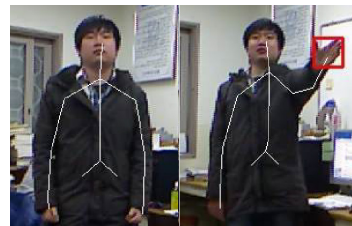
그림 1. 키넥트 센서를 이용한 손 위치 추적과정 Fig. 1. Hand position trajectory process using Kinect sensor.
