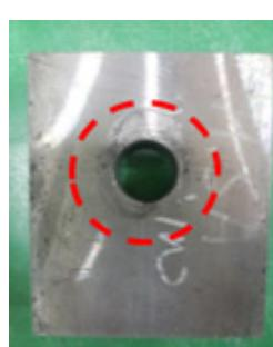
(d) Jig using nominal tensile strength 800MPa steel
