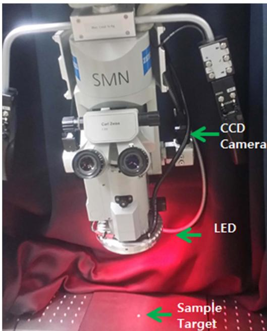
그림 3. 수술현미경을 이용한 형광 샘플 관측 실험.
