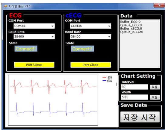
(b) PC monitoring program 그림 6. 모니터링 시스템의 실행결과
