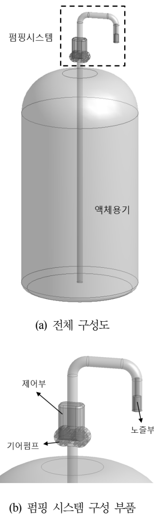
Fig. 1. 자동액체 분사장치 개요도
