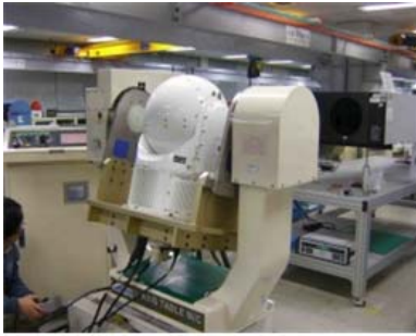
그림 9. 최소분해가능온도차 측정 시험 Fig. 9. MRTD measurement tests.
