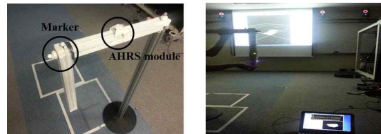
그림 8. Vicon을 이용한 AHRS 모듈 검증
