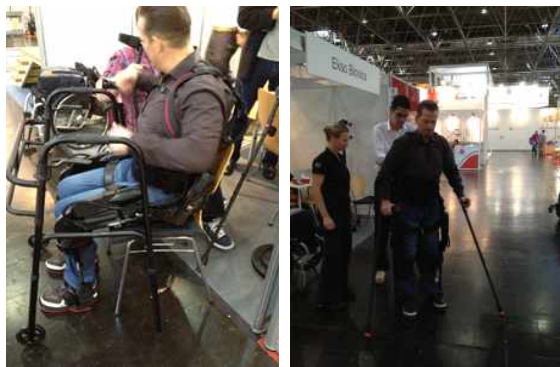
그림 16. 워커를 이용하여 기립을 준비하고 있는 Ekso 착용자. 발열에 대응하기 위해 구동기 근처의 배기 구멍이 새로 생김. Ekso를 착용하고 지팡이를 이용하여 기립한 상태에서 보행을 시작하고 있는 모습.
