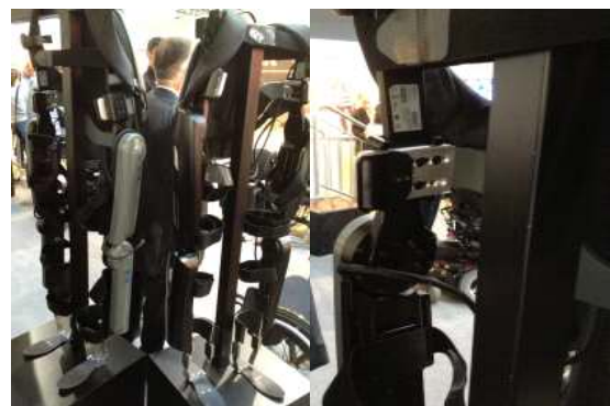
그림 15. 재활용도의 ReWalk(좌측)과 개인용도의 ReWalk(우측). ReWalk의 외골격 부분 안쪽 모습
