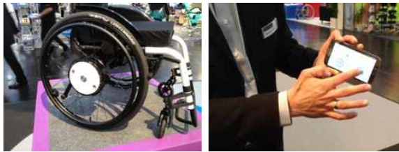
그림 10. Power Assist Wheel 및 스마트 폰을 이용한 Power Assist Wheel의 원격 제어. Power Assist Wheel의 핸드림에 센서가 장착되어 있는 입력 장치로 활용됨.
