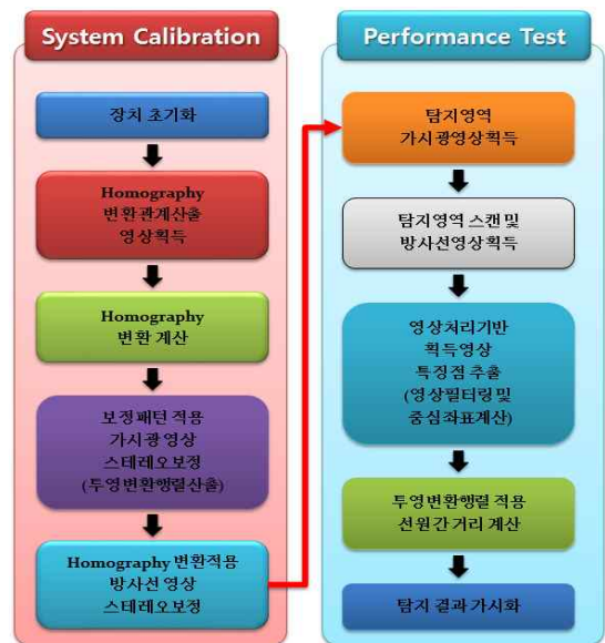
그림 7. 시스템 보정과정 및 방사선원 거리추출 절차 Fig. 7. Procedure of the system calibration and distance calculation of source.
