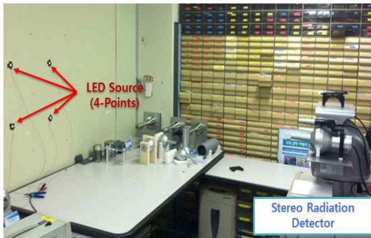
그림 8. LED 광원을 이용한 거리측정 실험 Fig. 8. Distance calculation test using LED source.
