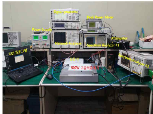
그림 11. 질문기(ITX) 테스트 셋업 Fig. 11. Test setup of interrogator.
