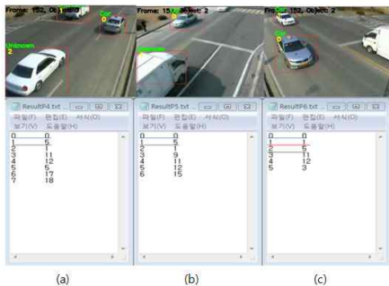
그림 14. 직선 도로에서 3대의 카메라 정보를 이용한 동일차량 추적 결과 Fig. 14. Tracking results of a same car by three cameras (SN5~SN7) at the straight road.
