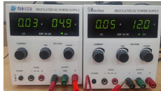
그림 10. 다양한 전원을 사용한 아날로그 보드의 소모전류 Fig. 10 Current consumption of the analog board to simplify power
