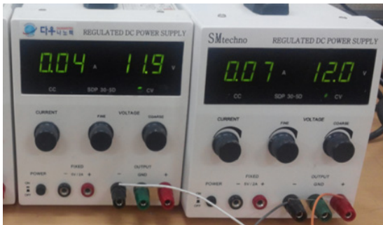
그림 9. 다양한 전원을 사용한 아날로그 보드의 소모전류 Fig. 9 Current consumption of the analog board with various power
