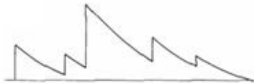
그림 3. 감마선 센서의 출력 신호 Fig. 3 Output signal of gamma-ray sensor
