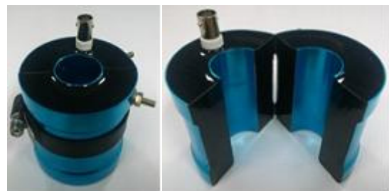
그림 11. 열차 내 무배선통신시스템 구현을 위하여 제작된 유도성 연결장치 Fig. 11 The developed IJT for implementation of an LLC in the TCN
