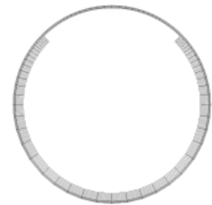
(d) Sectional view of Wall-thinning model
