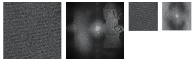
그림 7. 홀로그램의 다운 샘플링에 따른 복원 영상의 손실
