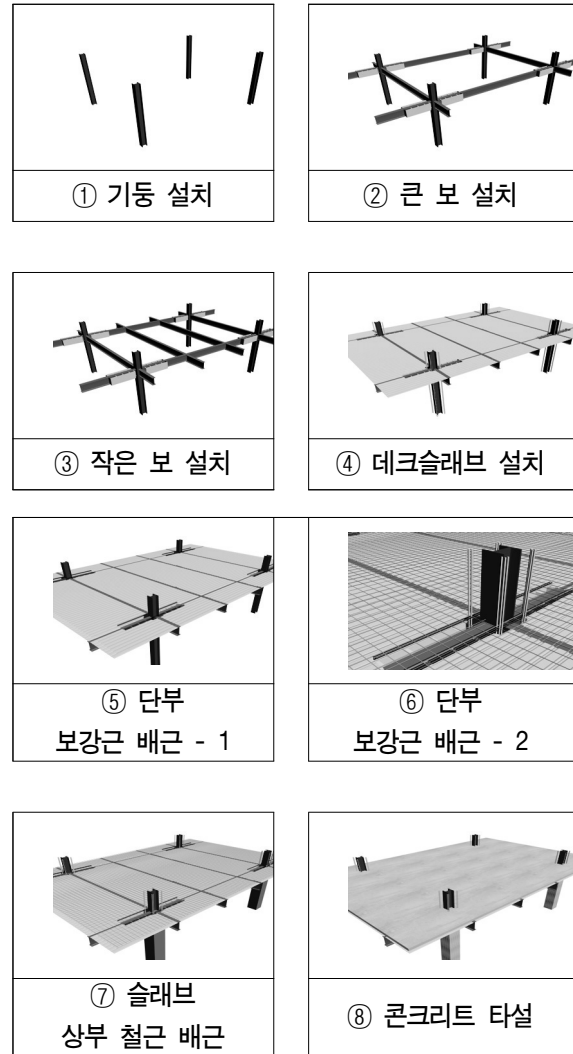
그림 7. Eco-Girder공법의 시공순서도
