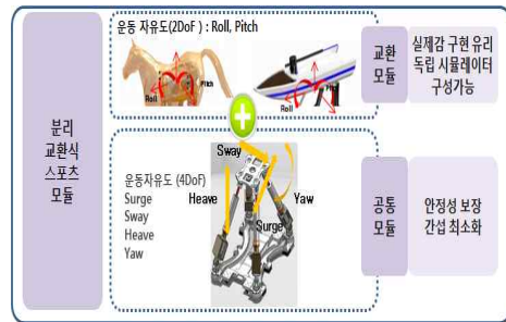
그림 7. 교환식 스포츠 모듈의 개념도 Fig. 7. The Concept of the Changable Sports Module
