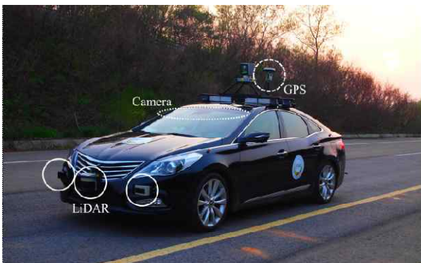
그림 9. 실험용 자율주행자동차. Fig. 9. Autonomous Vehicle for Road Test.
