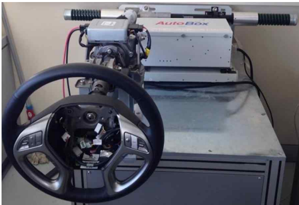
그림 2. 전기적 파워 조향 시스템의 모의 실험 장치. Fig. 2. The EPS HILS system.
