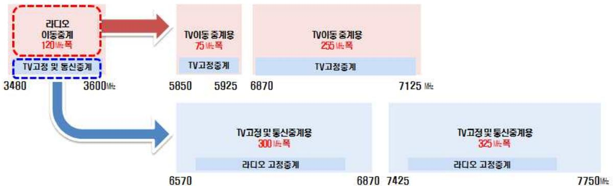
[그림 6] 일본 3,480~3,600 MHz 대역 라디오·TV 고정 및 통신중계용 M/W 주파수 재배치 계획.
