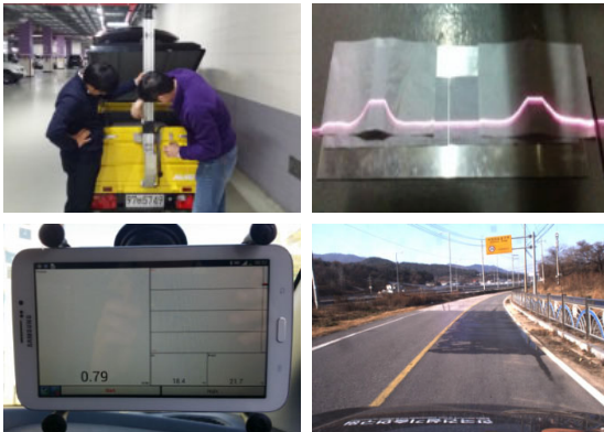
그림 4. 장비 캘리브레이션 및 노면상태 측정화면
