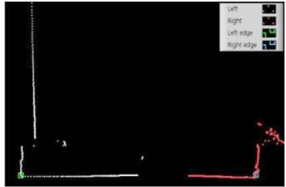
(a) 레이저 스캐너를 이용한 도로 폭 측정
