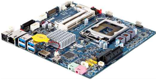
그림 8. 윈도우 임베디드 시스템이 운영 가능한 PC기반의 보드 MQ77TN (출처 MDS 테크놀로지)
