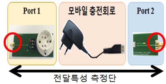
그림 8. 수동소자가 제거된 인터페이스 회로 Fig. 8. Measurement circuit without passive component.
