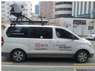
그림 9. 고정밀 전자지도 구축을 위한 모바일 매핑 시스템
