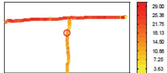
Fig. 7 이미지 영상 처리 기법을 통한 실제 균열 추정
