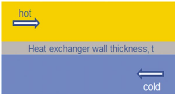
[그림 17] 대향류 열교환기의 열전달 및 열저항 구성
