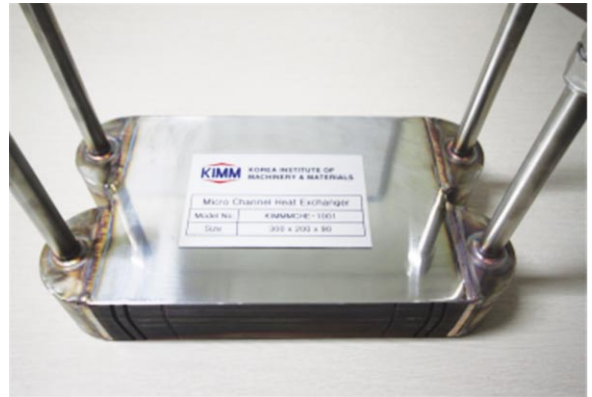
[그림 13] 확산접합 방식으로 제작된 인쇄기판형 열교환기 (한국기계연구원)
