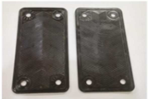
[그림 20] 폴리머 복합소재 단위 열교환 박판 설계 및 시제품(한국기계연구원)
