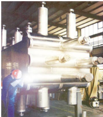
[그림 7] 극저온용 플레이트 핀 열교환기 외형(좌), 콜드박스에 장착되고 있는 모습(우)
