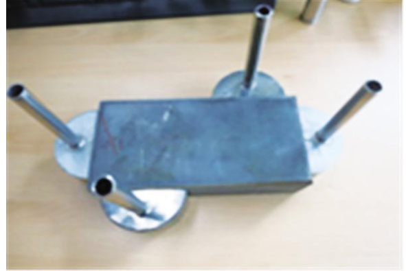
[그림 15] 확산접합설비 및 인코넬 열교환기(한국기계연구원)
