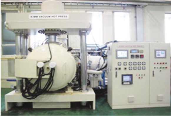
[그림 15] 확산접합설비 및 인코넬 열교환기(한국기계연구원)
