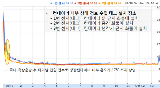
그림 6. 테스트 중 컨테이너 상부 온도 Fig. 6 The temperature of container(top) during the test
