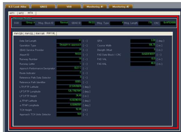
그림 16. 수신된 VDB MT4(활주로 14L FAS block)
