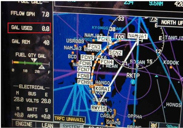
그림 7. NAMJA1에서의 curved approach 비행시험 조종석 내부 촬영
