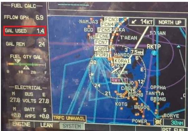
그림 8. RWY15에서의 curved approach 비행시험 조종석 내부 촬영
