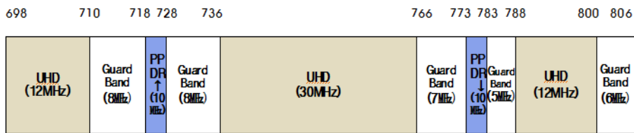
그림 11. 지상파 UHD 주파수 배치 방안 (MHz) Fig. 11. Frequency allocation plan for Terrestrial UHD TV
