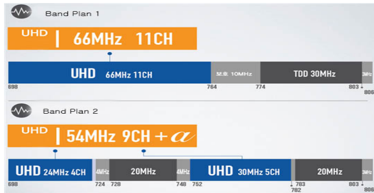
그림 1. 지상파 방송사들의 UHD 주파수 플랜 Fig. 1. UHD Frequency Plan proposed by terrestrial broadcasters
