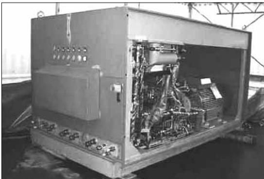
그림 3. Chubu 공항 건설시 사용된 준설토 이송 파이프 및 펌프 (PIANC 2009)
