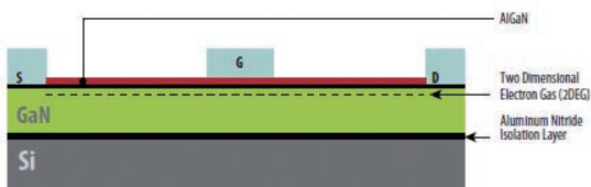
〈그림 11〉 전형적인 source, gate and drain, 3극의 메탈-반도체 컨택을 갖는 AlGaN/GaN HFET 구조(자료: WWW.EPC-CO.COM )
