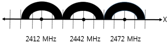
그림 1. WiFi 시스템의 비중첩 채널 Fig. 1 Non-overlapping channels of WiFi system
