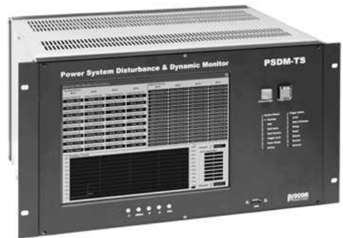
그림 4. 국내 업체 (주)프로컴 사의 전력계통 외란 감시기록장치 'PSDM-TS'
