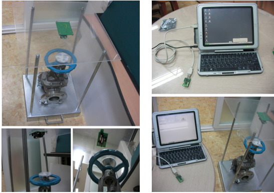
그림 8. 밸브개폐 측정시스템 실제 테스트 Fig. 8 The actual testing environment
