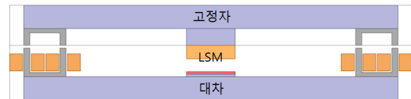
그림 2 부상 전자석을 적용한 자기부상 시스템 기본 모형 Fig. 2 The maglev system basic design using the levitation magnet
