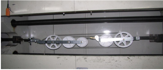
그림 7 장력조정장치의 파단 시험장치 Fig. 7 Testing facility for rupture tests for the pulley type tensioning device
