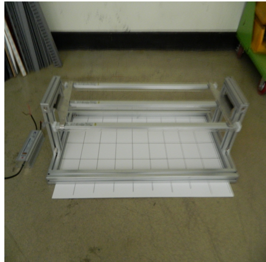
그림 12 LED 균일광 조사 시험을 위한 시험지그 Fig. 12 Test zig for uniform light irradiation tests of LED
