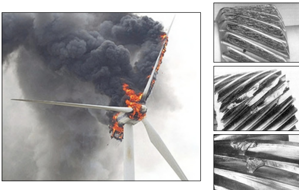
그림 1 종래 기계적 기어박스의 화재 및 손상 Fig. 1 Gear failures and fire of conventional mechanical gearbox
