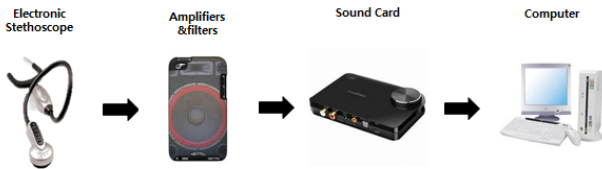
그림 4 심음 수집 시스템 Fig. 4 Phonocardiogram acquisition system
