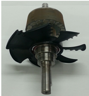
그림 6 냉각팬 Fig. 6 Cooling fan of rotor
