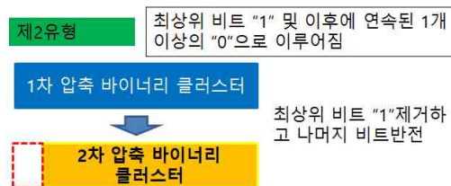
그림 5. 제 1유형 1차 압축바이너리 클러스터의 압축 Fig. 5. Diagram of compressing the type 2 primary compressed binary cluster into secondary compressed binary cluster
