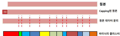
그림 2. 원본데이터로부터 바이너리 클러스터로의 분리 Fig. 2. Diagram of process for compartmenting original data into binary clusters
