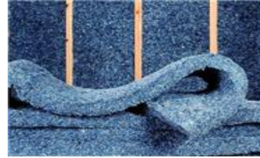
<그림 4> House insulator made from used jeans 2010, legendblues - http://www.legendbluesllc.com
