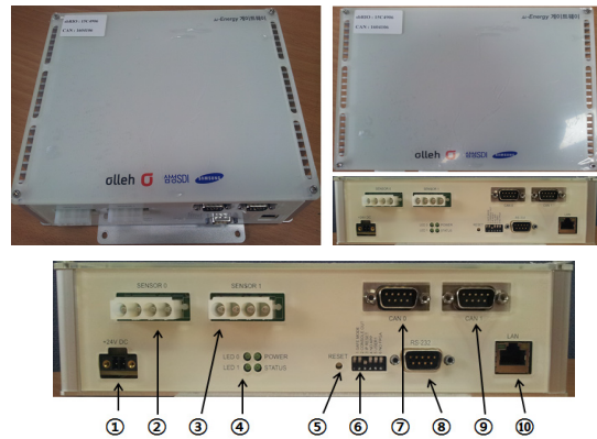
그림 8. Micro-EMS 외함 및 입출력 단자 Fig. 8. Micro-EMS housing and output terminals.
