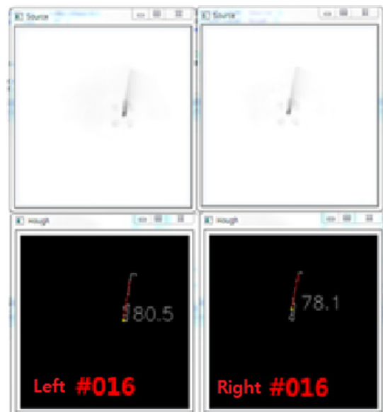
그림 6. 적외선 스테레오 카메라에서의 막대 회전각도 측정 Fig. 6. Rotation angle measurement of a stick in the IR stereo camera.
