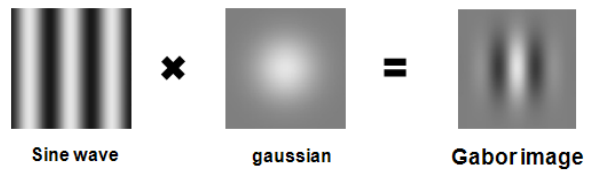
그림 1. 사인 격자와 가우시안 엔벨로프로 만들어진 가보 영상의 예 Fig 1. An example of a Gabor image, which is created from a sine-wave grating convoluted with a gaussian window
