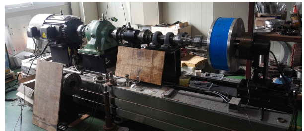
그림 2. 풍속 변화 모의실험을 위한 M-G 세트 Fig. 2. M-G Set for Simulation of Wind Velocity Change
